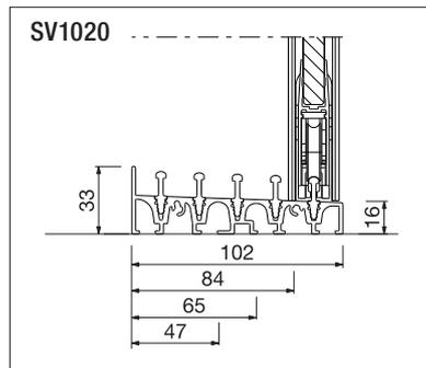
Bodenschiene Standard (2-5-spurig)
